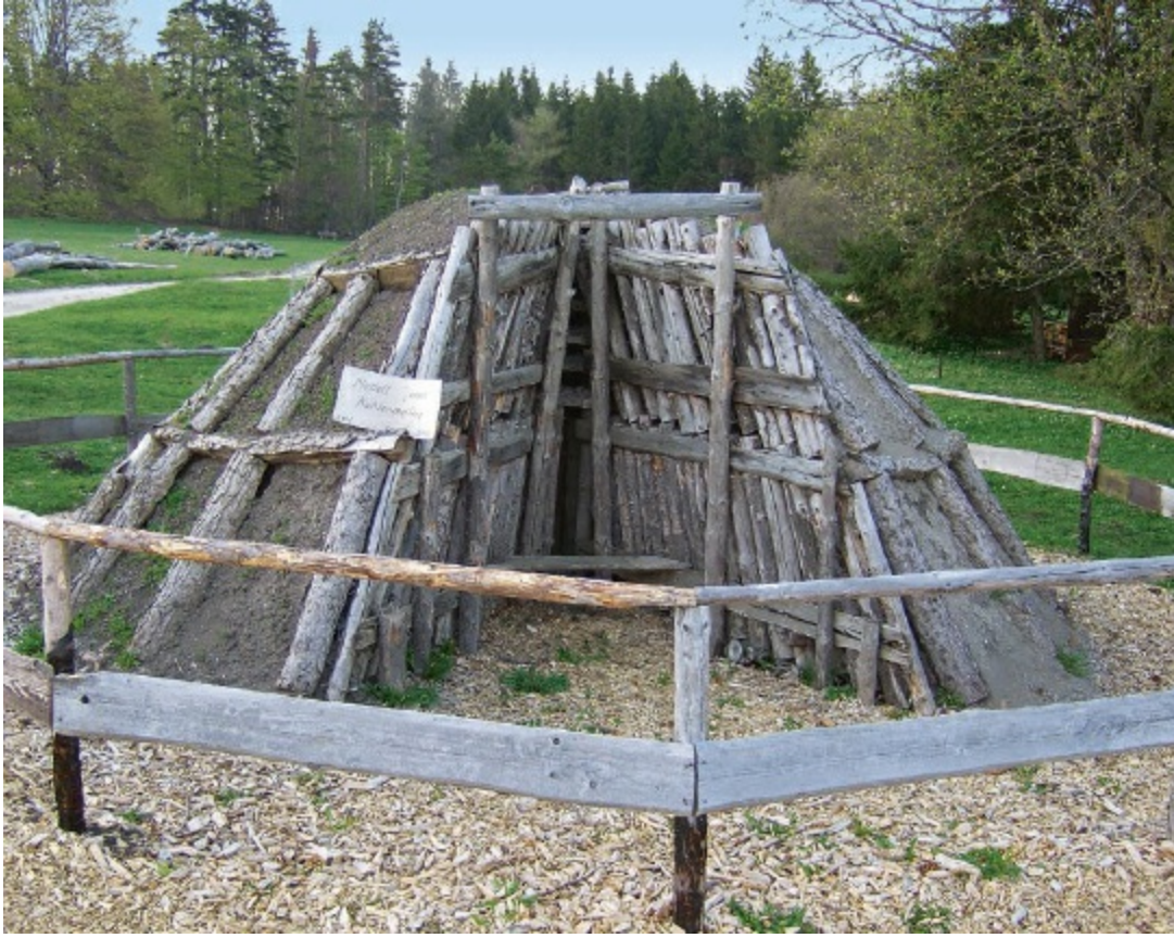
Modell eines Meilers zur Holzverkohlung (Albstadt Onstmetting).
