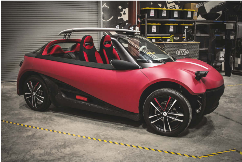
Abb. 1.1: Kfz aus dem 3D-Drucker von Local Motors
