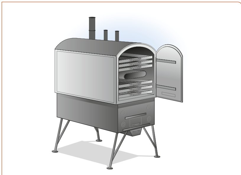
In einem solchen, mit Holz beheizten Trockenschrank aus Metall konnte eine Menge Obst auf einmal getrocknet werden. Aus einer Anleitung aus dem Jahr 1881.
