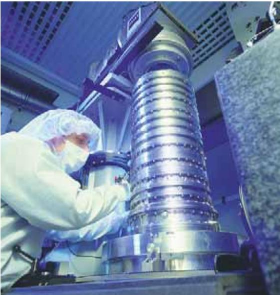
Abb. 1.5: Hochleistungsobjektiv für einen Wafer-Stepper /Zeiss04/
